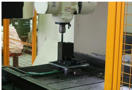
図1 砂型の切削実験
