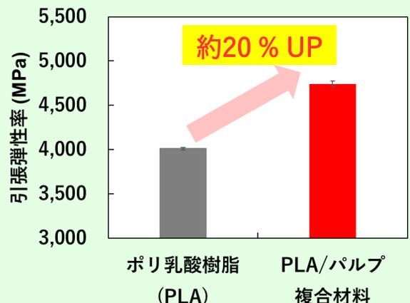
引張試験における弾性率測定結果
