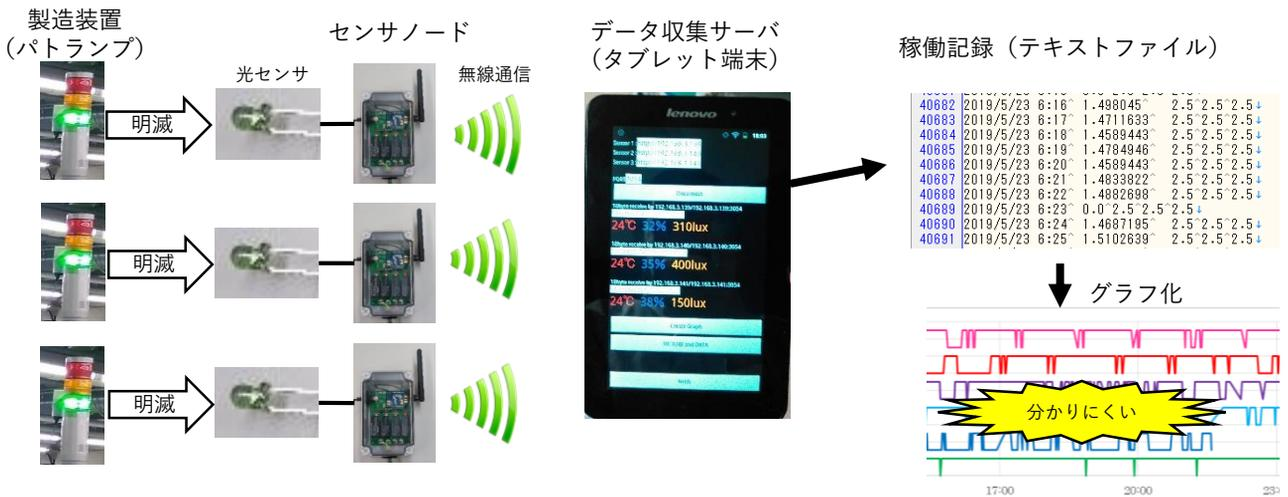
図1 製造装置の稼働監視の模式図
