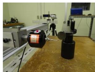
図3 電気式トリガプローブ
