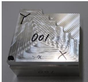
図2 XY軸加工精度確認用モデル
