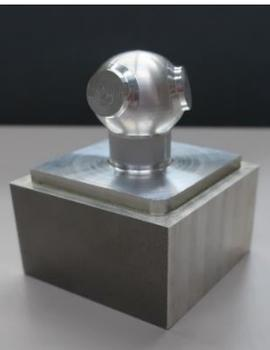
図5 5軸加工精度確認用モデル
