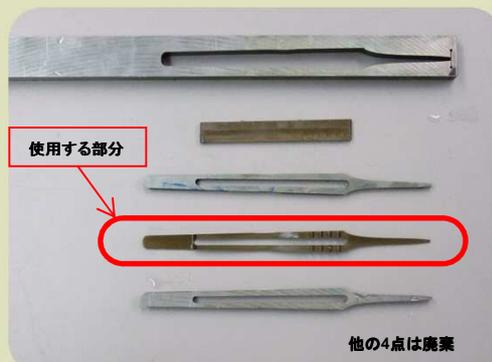
図2 ワイヤー放電加工で切り出した部品
