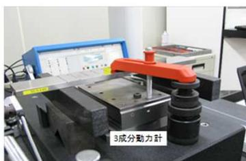
図2 クランプ力の計測
