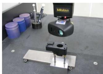
図2 プローブを横向きに切替
