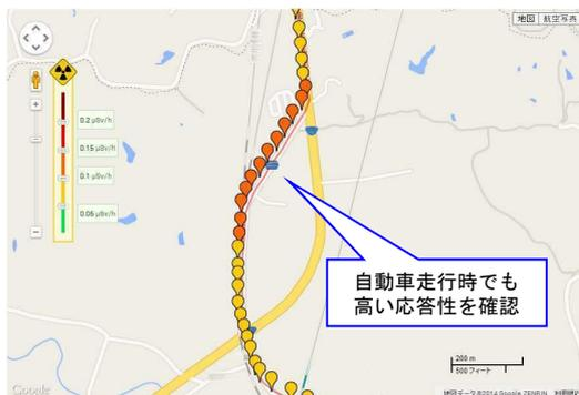
図2 自動車走行中の車内測定結果
