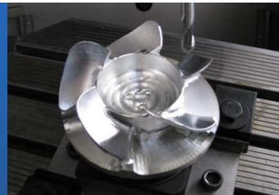
図4 5軸M/Cで加工したファン翼
