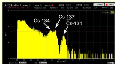
図4 放射性セシウム体積線源のスペクトル
