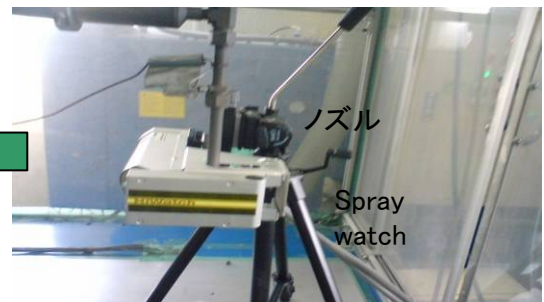
図2 有機粒子の飛行速度計測方法
