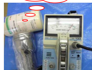
写真3 自然界に存在する放射性カリウムK-40の放射線測定( \beta , \gamma 線)の様子
