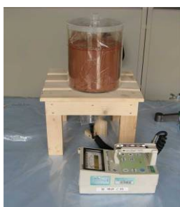
写真1 NaIシンチレーションサーベイメータを用いた簡易放射能測定(遮蔽なし)
