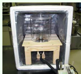
写真2 鉛箱(鉛3mm厚)で環境放射線を遮蔽した測定
