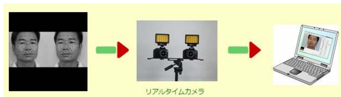
図1 2台のカメラ画像による3次元計測の流れ
