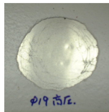
図2. 鉄板に塗装した白線塗装の剥離試験
