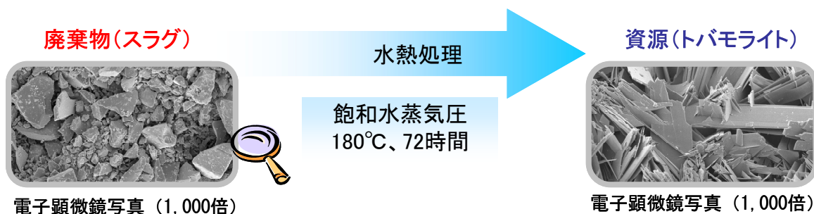
図 1. 水熱処理を用いたスラグからトバモライトの生成
