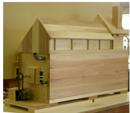
図2. 試作した「横型」木製醗酵槽
