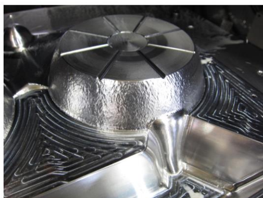
図3 NC加工したマッチプレート
