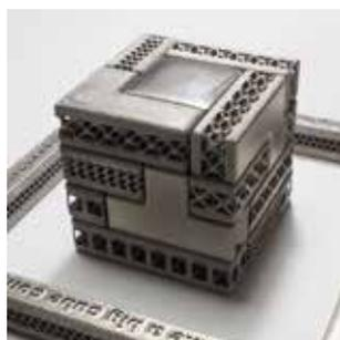
EBMで試作した造形品
