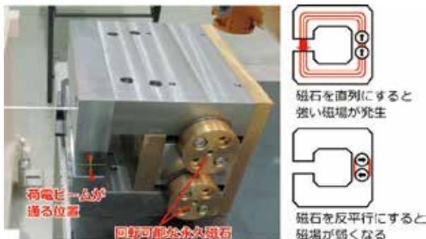
試作した永久磁石回転式磁場調整機構
