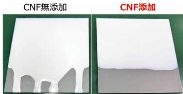
CNFの添加による液だれ抑制の様子
