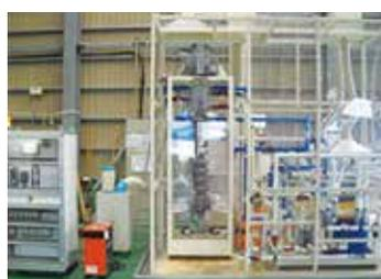
開発中の縦型電解研磨装置
