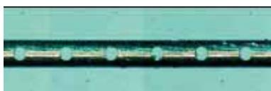
写真② φ0.08mmの細穴加工品
