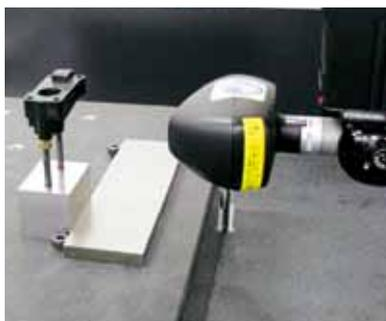
レーザプロブ型三次元測定機
