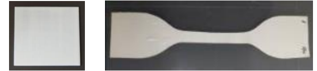
試験片外観 (左:硬度試験、右:引張試験)
