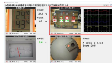
製造装置をカメラで撮影しランプと液晶の情報を読み取る
