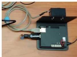
製造装置をカメラで撮影しランプと液晶の情報を読み取る
