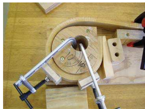
写真6 座部品の曲げ加工の様子と治具
