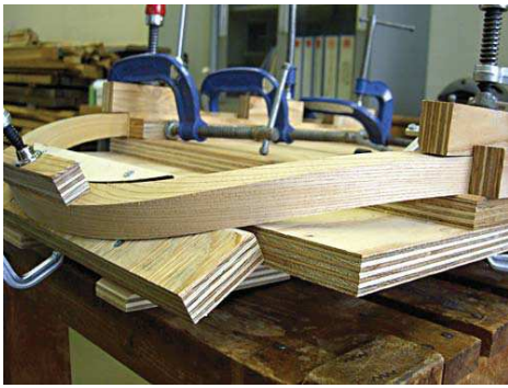
写真7 背もたれの3次元曲げ加工
