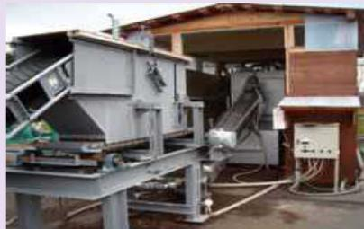
図2 樹皮を燃料とする小型蒸気ボイラーシステム
