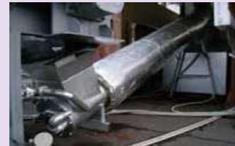
図3 蒸気と排ガス利用による樹皮含水率低減装置
