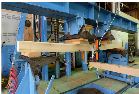
写真1 ユリノキ105mm角の曲げ試験
