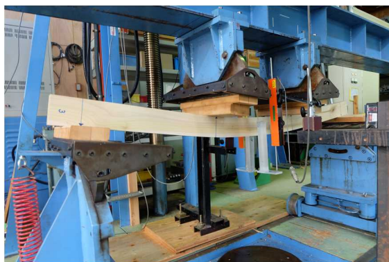
写真2 ユリノキ2×4材の曲げ試験
