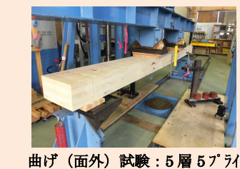
図1 弱軸試験体と曲げ試験（左）と試験結果（右）
