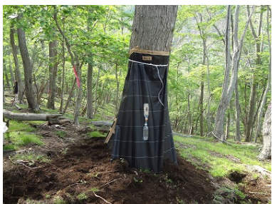
写真 伐根（写真上）と立木（写真下）に設置したスカートトラップ 対象を遮光性資材で覆い、明かり穴を開けて、そこに集まったカシノナガキクイムシを捕獲する仕組み。
