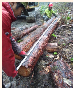
【末口径測定】 【長さ測定】 写真 材積測定の様子
