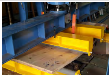
写真1 合板のJASに基づく曲げ強度試験
