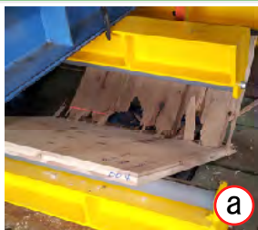
写真3 曲げ試験別の破壊形態
