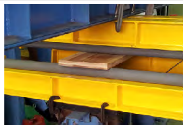
写真2 CLTのJASに基づく曲げ強度試験
