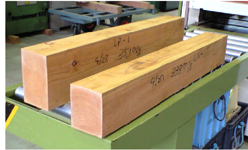
写真1 同一丸太から製材したカラマツ心持ち平角材(左)と心去り平角材(右)
