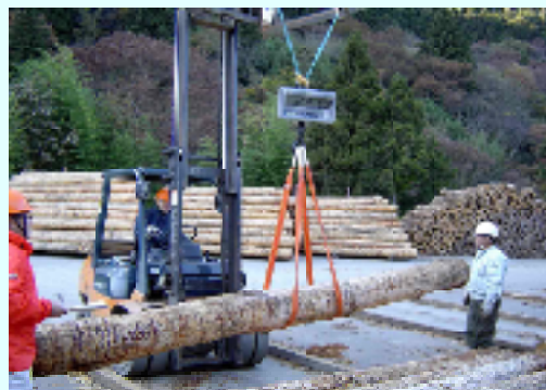
写真1 アカマツ丸太の動的ヤング係数の測定
