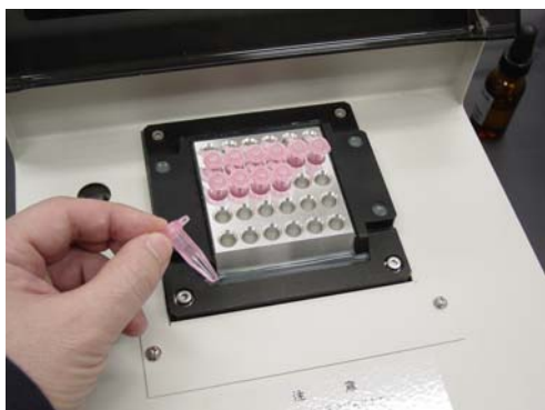
写真-1 加熱処理の様子 遺伝子実験で用いる温度制御装置（サーマルサイクラー）とチューブを用いて正確な温度調整を行った。
