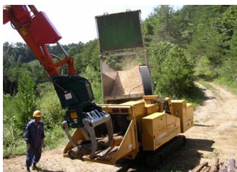
写真1 移動式チッパーによるチップ化の状況
