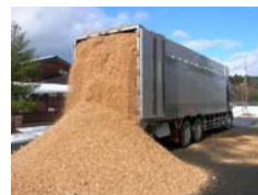
写真-3 強制排出装置付 12t トラック
