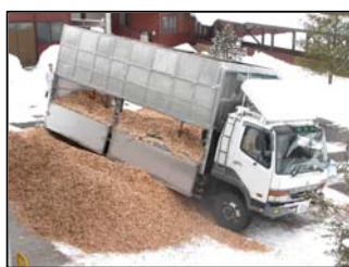
写真-2 (手降ろし) 10t チップ運搬車 最大積載量：7,750kg 荷台容積：38m 3
