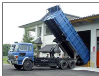
写真-1 10t 深アオリダンプ 最大積載量：7,250kg 荷台容積：25m 3
