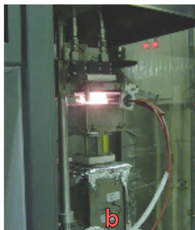
写真1 試作したアカマツ防火処理材料(a)と防火性能試験装置(コーンカロリメータ)(b)
