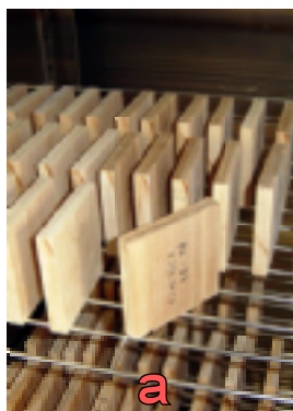
写真1 試作したアカマツ防火処理材料(a)と防火性能試験装置(コーンカロリメータ)(b)
