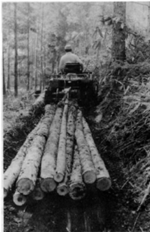
写真-3 コマツユニカによる玉ぞりけん引
