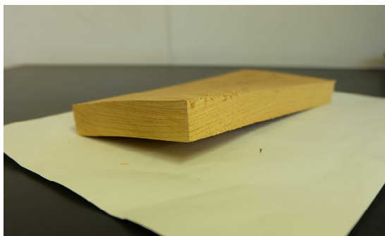
写真7 ケヤキ試験体(ねじれ)
