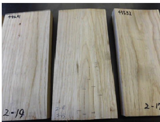
写真2 ミズナラの初期割れ（材面割れ）
