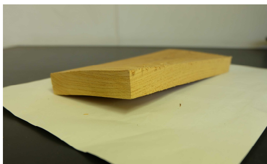
写真7 ケヤキ試験体(ねじれ)
