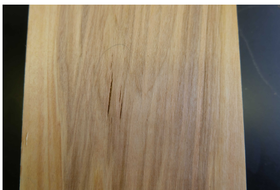
写真4 シラカバの初期割れ（材面割れ）
