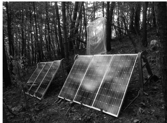
図5 ソーラーパネル(プロット2，プロット3) 後方はオーブントップチャンバー(OTC)。
