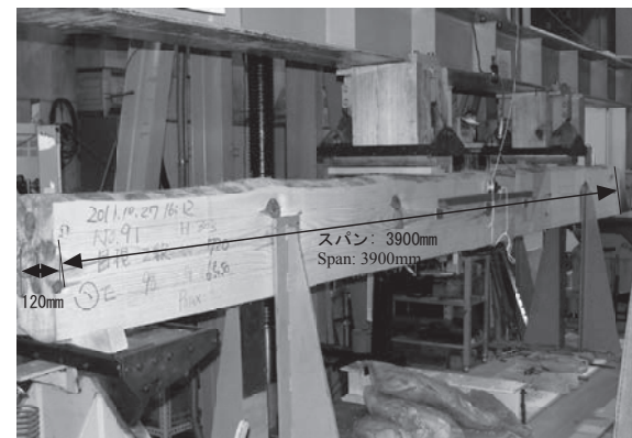
図 3.1.1 アカマツたいこ材の静的曲げ試験 Fig. 3.1.1 Static bending test for two-side-surfaced timber.
