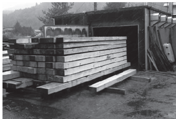
図 3.2.1 アカマツ平角材の高温セツト法による人工乾燥
