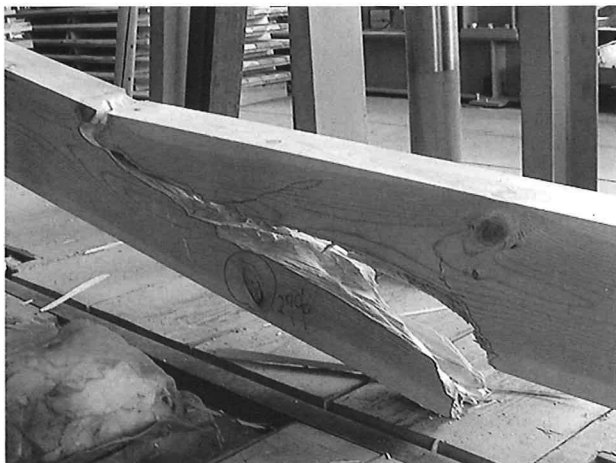
写真-3 単独節からの目切れ破壊
