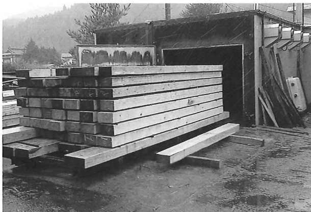
写真-1 アカマツ平角材と蒸気式高温乾燥機
