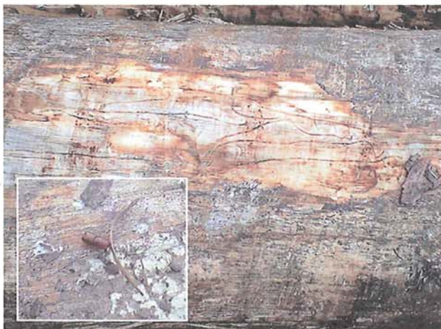
写真-1 貯木後の丸太と樹皮下キクイムシ食痕 (無処理, 60日間貯木後)
