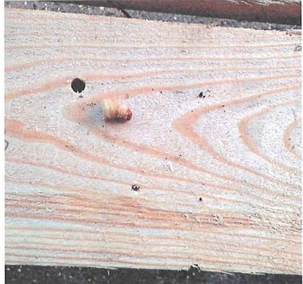
写真-3 丸太の側板に確認したゾウムシの幼虫と穿孔痕(無処理, 60日間貯木後に製材)
