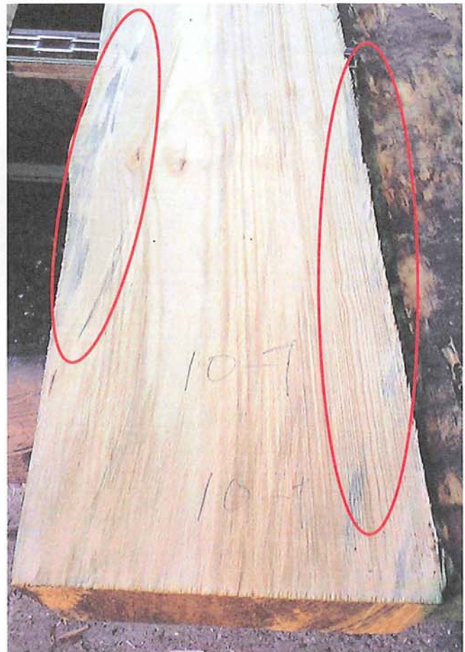
写真-2 丸太の側板に確認した青変部位 (無処理, 60日間貯木後に製材)
