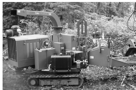
写真-1 切削型チップパー 最大処理径：30cm エンジン出力：80馬力
