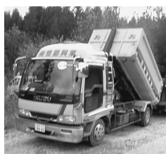
4 t 脱着式ダンプ 最大積載量：2,900kg 荷台容積：8.1m 3 チップ積載量：8.1m 3
