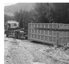
12 t 脱着式ダンプ 最大積載量：9,100kg 荷台容積：27.1m 3 チップ積載量：27.1m 3
