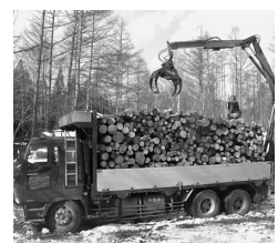
ローダークレーン付10tトラック 最大積載量：10,000kg チップ丸太積載量： 約13m 3
