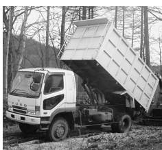
4 t ファームダンプ 最大積載量：2,400kg 荷台容積：16.4m 3 チップ積載量：7.2m 3
