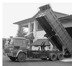
10 t 深アオリダンプ 最大積載量：7,250kg 荷台容積：24.7m 3 チップ積載量：22.0m 3
