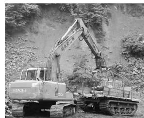
写真-2 フォワーダ 最大積載量：6,000kg
