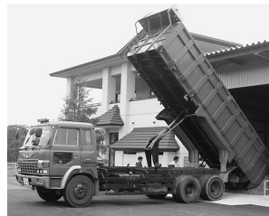
写真-5 (残材積込) 10t深ダンプ 最大積載量：7,250kg 荷台容積：25m 3
