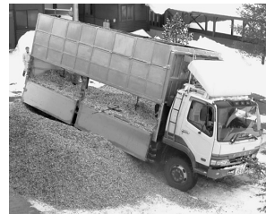
写真-6 10tチップ運搬車 最大積載量：7,750kg 荷台容積：38m 3
