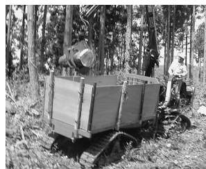
写真-1 グラップル付フォワーダ 最大積載量：2,700kg
