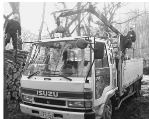
写真-4 ロードークレーン付4tトラック 最大積載量：2,750kg
