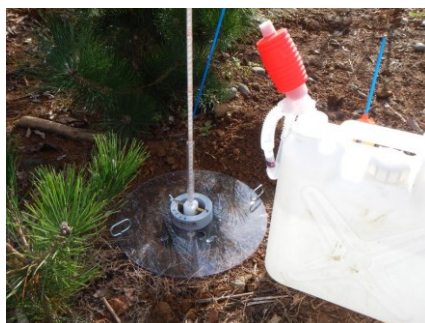
長谷川式現場簡易透水試験の様子
