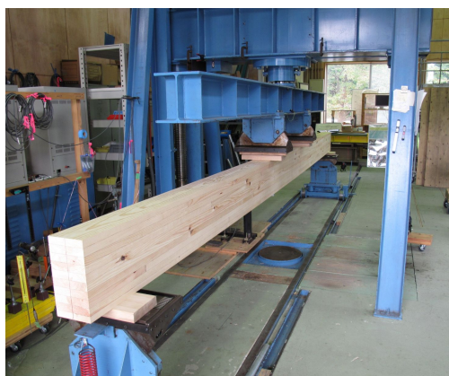
写真1 アカマツ集成材の曲げ試験 曲げヤング係数は10~11GPa、最大荷重7~9t
