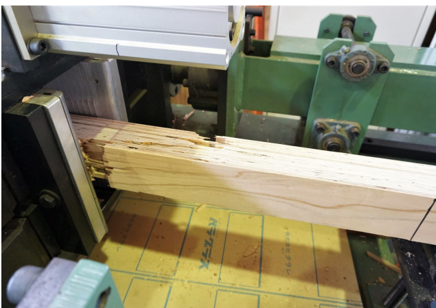
写真2 引張試験によるLVLの破断 材料の両端をつかみ、引張り材料を破壊 本試料の最大荷重は約12t
