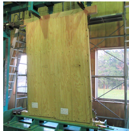
写真3 壁材の面内せん断試験 土台をフレームに、梁の左端をアクチュエーターに固定 梁材を左右に動かし、壁材を変形させ、壁倍率等を測定
