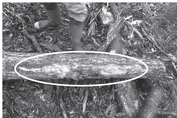
写真4 プロセッサ送り装置の接触傷
