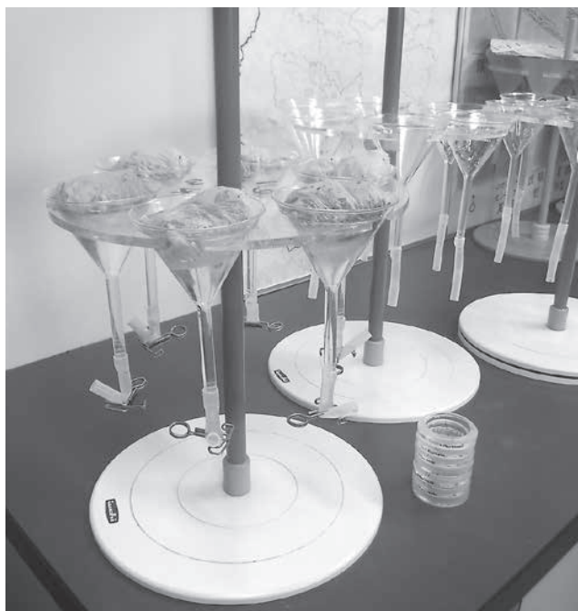
写真1 ベールマン法による抽出状況
