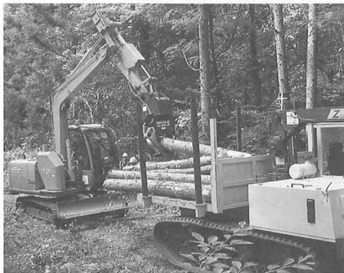
写真1 グラップルによる積込み
