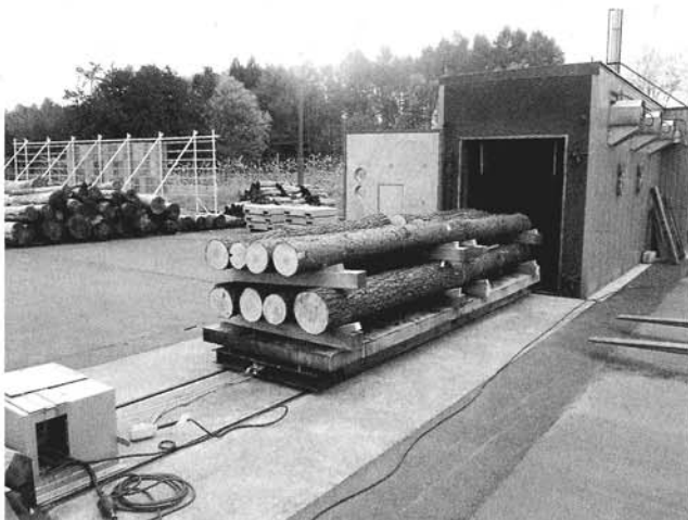
写真1-木材乾燥機での熱処理(出材状況)
