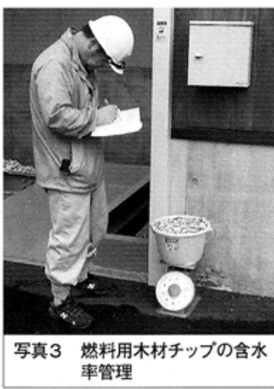
図 チップ重量と含水率との関係 1. 含水率（乾量基準）の管理値は120%以下とする。 2. チップ重量は、所定のバケツ（10L:360g）にすり切り一杯チップを入れ、その総重量を測定する。
