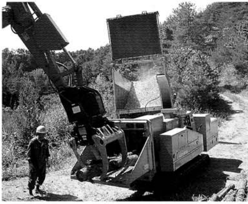
写真1 移動式チッパーによるチップ化
