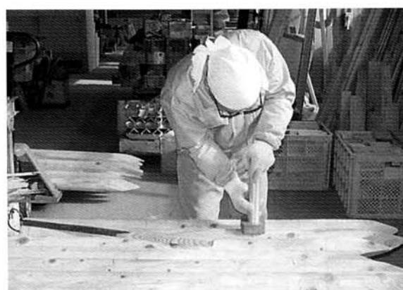
写真2 ピロデイン打ち込み深さの測定
