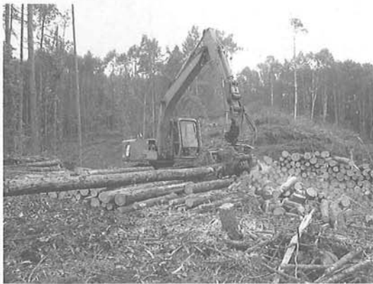
チェーンソー伐倒→プロセッサ造材
