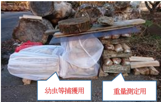
【写真1】 検体の設置状況
