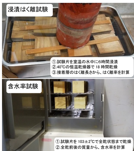
写真1 広葉樹クロスパネルの品質試験
