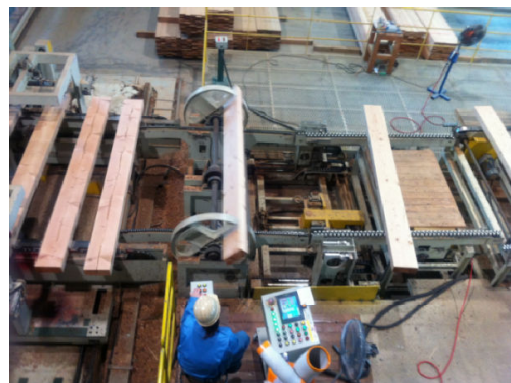
写真3 材面の目視検査
