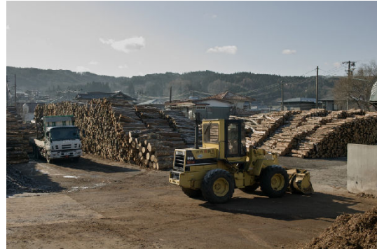
写真1 工場貯木場 ①4000m 3 /月の丸太(N,L材)をチップ化、②三菱製紙八戸工場へ出荷、③現在は素材生産事業体の救済のため、3か月分を貯木している、出荷の目処が立たない、④針葉樹丸太にはABC材が混在
